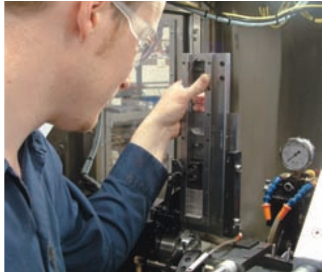
ローダーはワークに適した設計により、最大長さ 100mm、外径は 3mm から 10mm までのワークサイズに対応。
