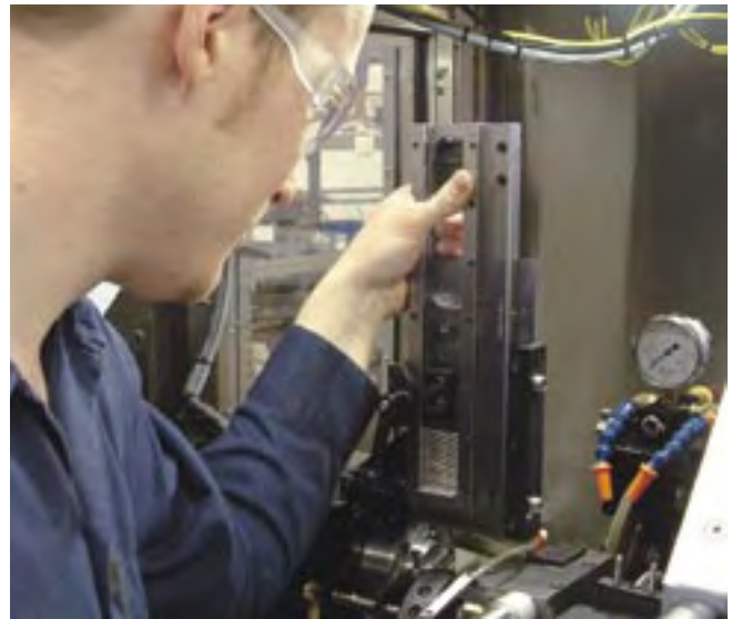
通过适当的工具, 送料装置可处理长达 100 mm 及直径达 3 mm 至 10 mm 的零件。
